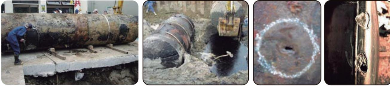
▲1960年設置のタンク ▲漏洩タンクの底部土壌 ▲計量口直下に空いた孔 (外面:3×7.5mm) ▲電食が原因の孔 (埋設後約8年のタンク)
