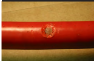
⑤ 熱による損傷：被覆層の溶け
