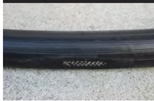
⑤ 熱による損傷：被覆層の溶け
