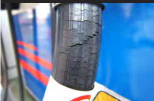
⑤ 熱による損傷：ひび割れの発生
