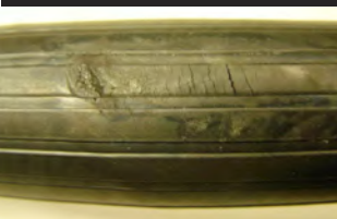
⑤ 熱による損傷：ひび割れの発生
