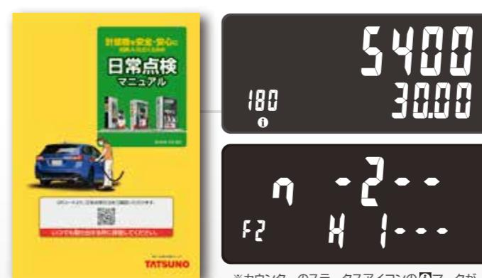
※カウンターのステータスアイコンの①マークが点灯したら、リモコンで交換時期にきた該当品を表示することができます。
