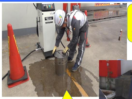
バッテリー計量機の鍵を廻して 電源を入れ フリー給油押して給油開始する フリーを押さないと10Lで停止します 変更する際は取り扱い説明P22を参照
