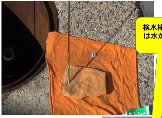
検水棒を引き抜き 色の変化の高さ分 は水が有るので、吸入パイプを下ろす 高さを調整する。
