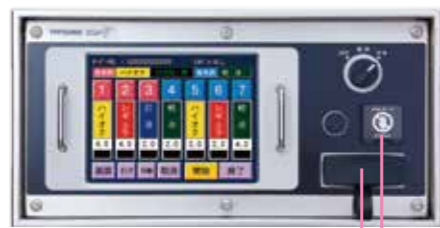
ICカードリーダー(マスターのみ) USBポート(マスターのみ)
