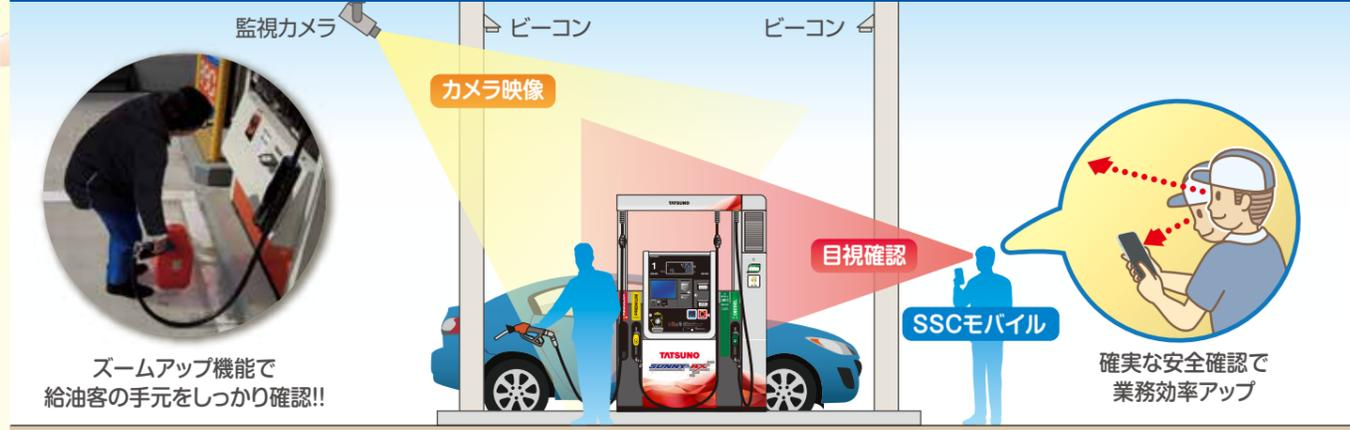
※法令により目視確認による給油許可が必要となります。モバイル端末の監視カメラ画像表示は給油許可を目視で確認する際の補助機能となります。
