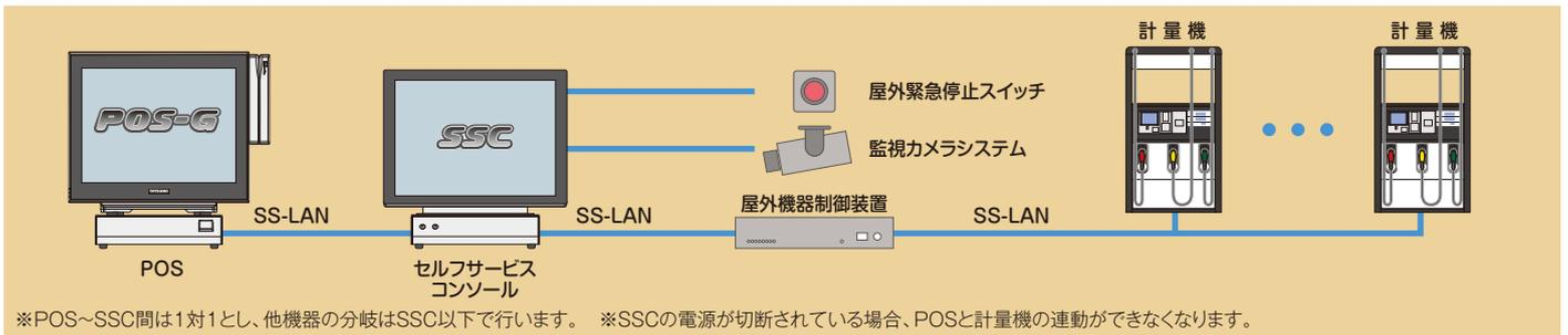
※POS~SSC間は1対1とし、他機器の分岐はSSC以下で行います。 ※SSCの電源が切断されている場合、POSと計量機の連動ができなくなります。
