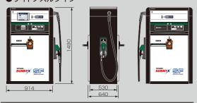
※上図は軽油の場合です。他の油種の場合、キャップ置き仕様が異なります。 ※両面対応の場合でも操作パネル、プリンターは片面装備となります。 ※両面対応の場合、背面の給油量表示位置は中央になります。
