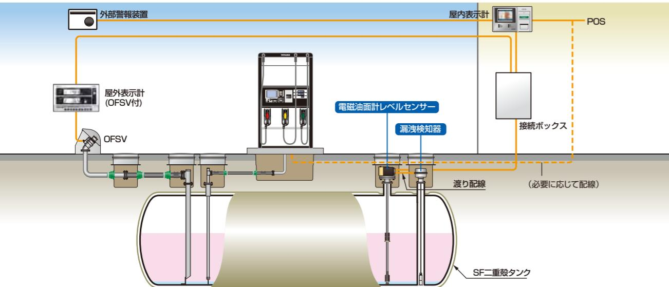
※渡り配線方式を採用しない場合には、漏洩検知器、タンク漏洩センサーはそれぞれ単独配線となります。
